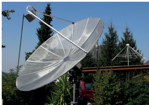
Abbildung: Parabolantenne (D1m9) mit einem Durchmesser von 1.9 Meter und mit einem Horn – einem ausgedienten Milchkeßli – abgestimmt auf die Frequenz des neutralen Wasserstoffs bei 1420 MHz. Direkt am Horn ist auch der Frontend-Verstärker (Nooelec SAWbird) montiert. Damit möglichst wenig Störungen eingekoppelt werden, ist es wichtig, diesen Frontend-Verstärker so nahe wie möglich am Dipol anzuordnen.
